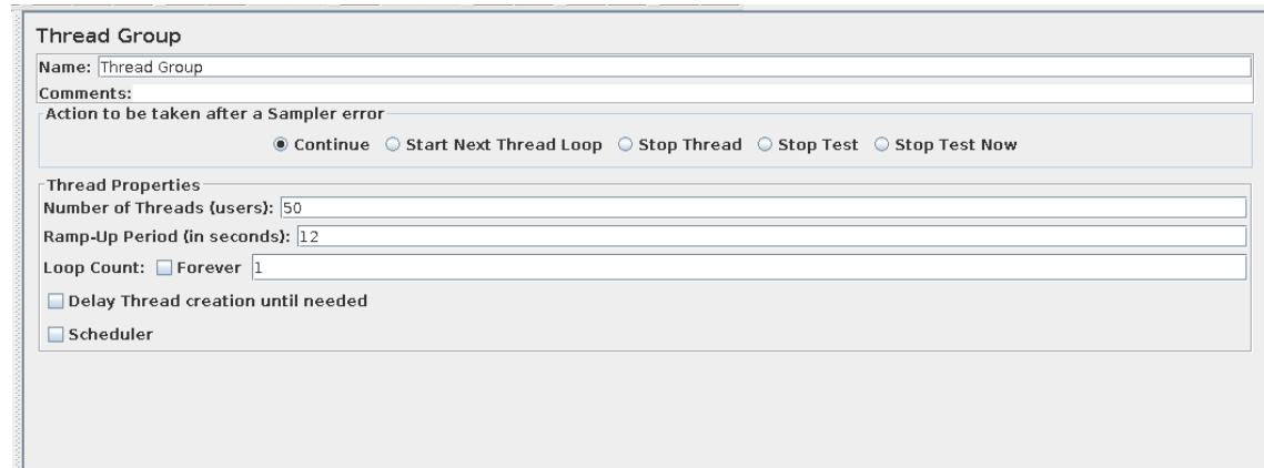
Σχήμα 5.9: Το συστατικό Thread Group των πειραμάτων του Apache JMeter
